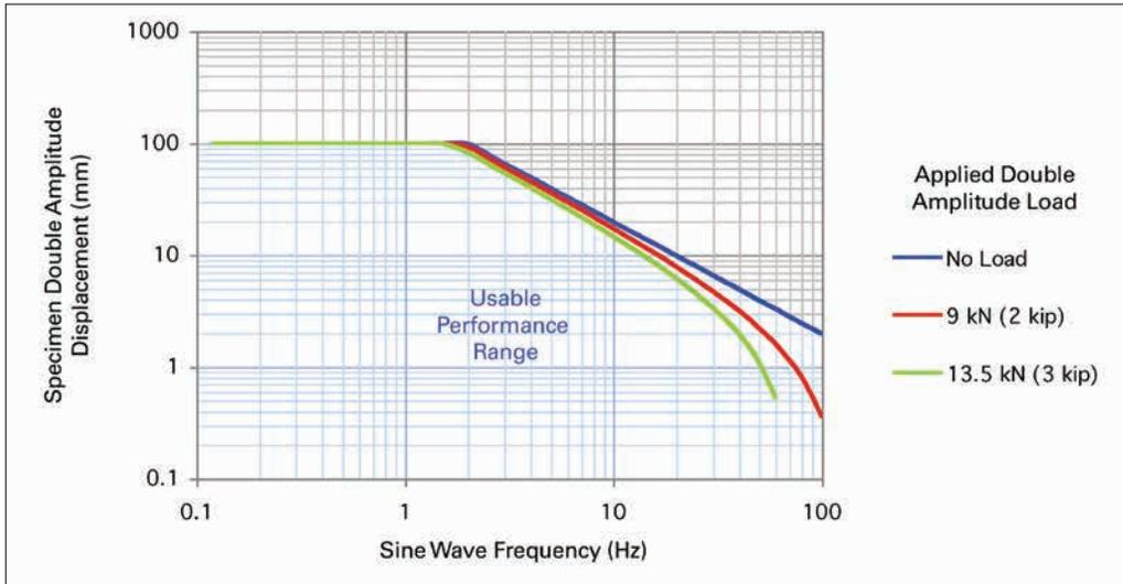
**ACTUATOR STATIC FORCE:** 15 kN (3.3 kip)
