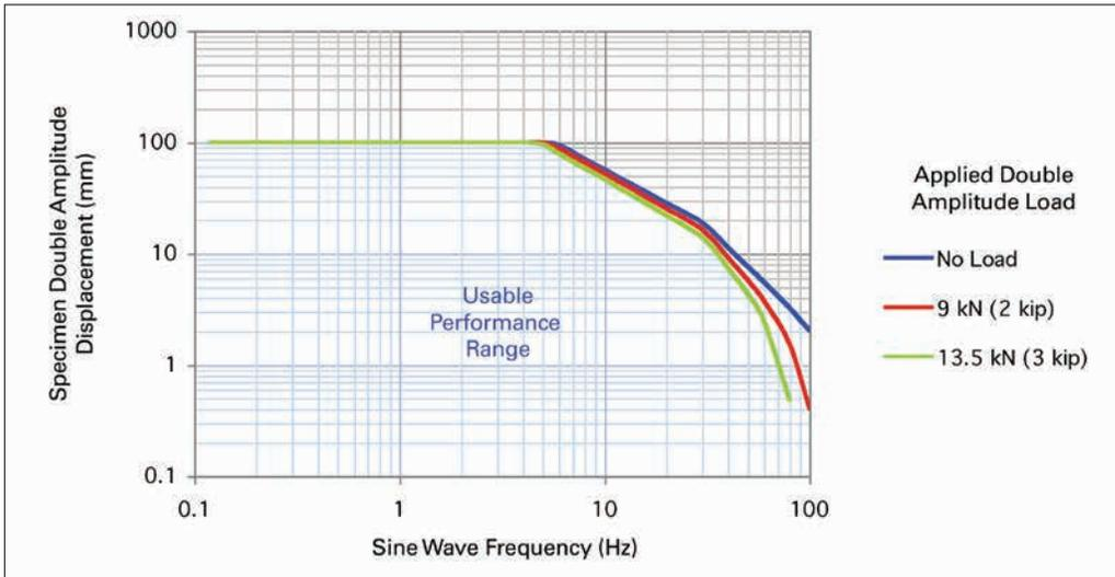
**ACTUATOR STATIC FORCE:** 15 kN (3.3 kip)
