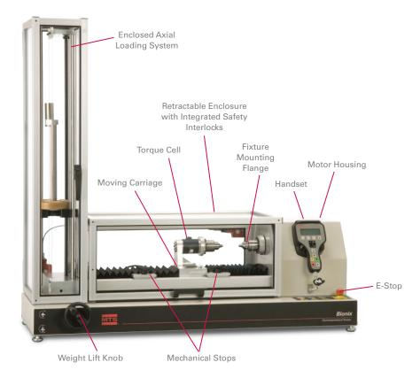
**Bionix EM Torsion System Components**
